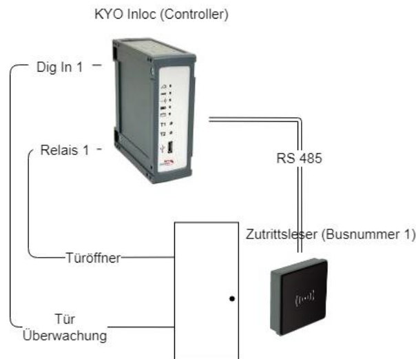
Abbildung 1 Aufbau einer überwachten Tür
