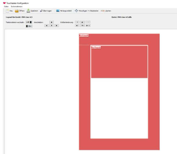
Aktivieren Sie „Hinzufügen Touchposition“, um einzelne Tasten zu erstellen. Mit jedem Klick in die Fläche, die für Tasten zugelassen ist, wird eine weitere Taste hinzugefügt.
