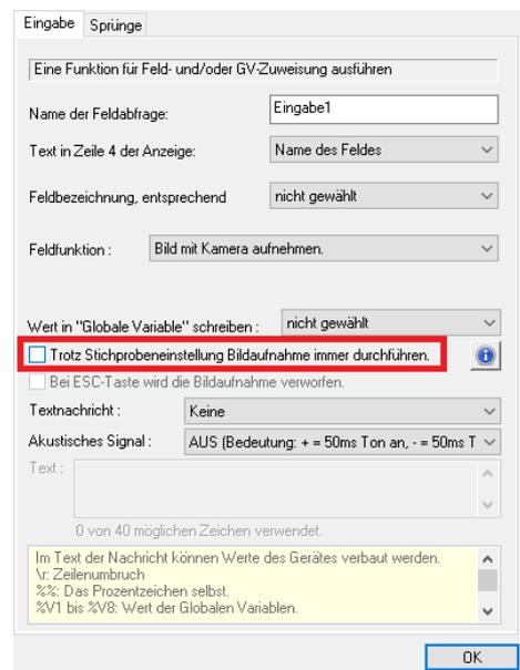
Abbildung 5 Kamera-Feldfunktion bei einfacher oder stichprobenartiger Bildaufnahme per Feldfunktion
