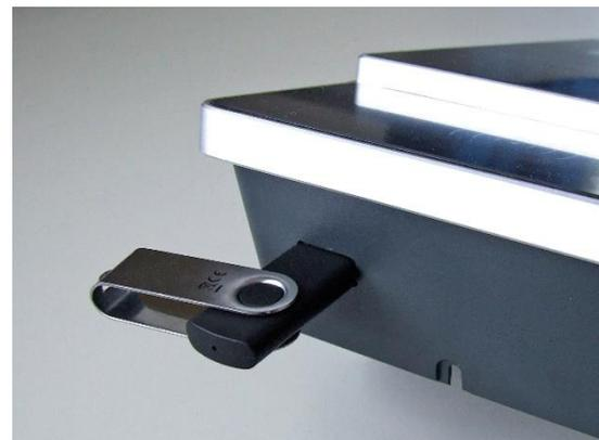
Der USB- Stick wird automatisch erkannt. Hierzu muss die Hauptkommunikation auf USB-Host stehen. Sie sehen die direkt im Display an diesem Symbol (Icon)
