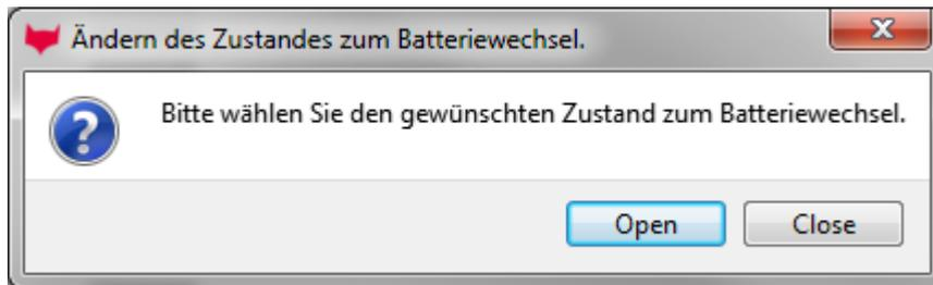
Bei „Open“ wird der Befehl zum Öffnen an das FSM gesendet. Dieser hält den Befehl solange vor bis eine Funkverbindung zustande kommt. Das kann durch Drehen oder Vorhalten eines Transponders realisiert werden. Anschließend werden die Sperrbolzen der Haube entriegelt.
