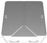
Das Türmodul (**TM**) enthält Relais, um einen Türöffner anzusteuern. Das Türmodul wird als reine elektronische Baugruppe angeboten. Es kann in eine Unterputzdose oder in einer Aufputzdose (links dargestellt) mit Sabotagekontakt montiert werden.
