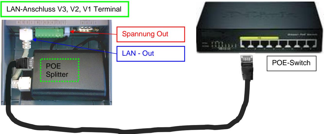
Variante 2: „Einspeisung POE“ über einen separaten Einspeiser:
