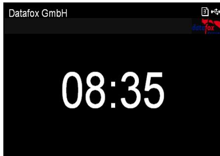
Die Umstellung erfolgt im Biosmenü des Gerätes unter dem Menüpunkt: „Benutzereinstellungen“ → „Anzeige / Signallautstärke“ → „Display-Layout“. Tippen Sie einfach auf den Eintrag „Display-Layout“ um zwischen MasterIV und Evoline Style umzuschalten.
