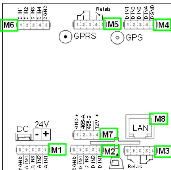
Hier sehen Sie, dass die IO.Box V4 über **8** Modulplätze verfügt. Diese können nun individuell bestückt werden.
