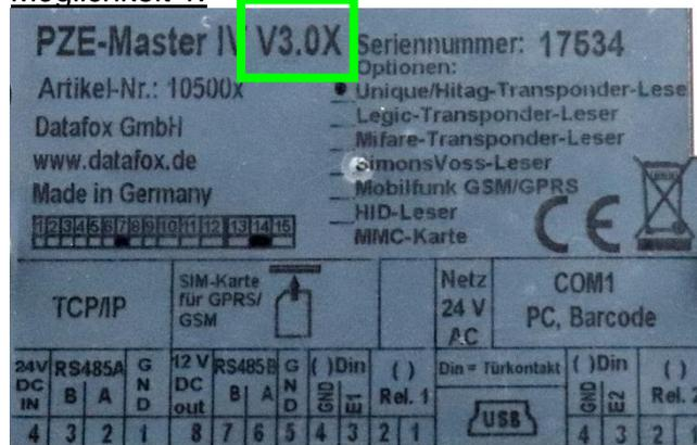
Schauen Sie auf das Typenschild. Dies finden Sie auf der Rückseite des Gerätes. Hier ein Beispiel für einen PZE-MasterIV **V3**.
